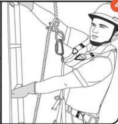
**4** Fije el freno a la línea de vida, coloque un mosquetón al freno y ancle la argolla externa o dorsal (dependiendo el freno y la actividad a realizar) del arnés de cuerpo completo al mosquetón como se muestra en la figura, al terminar revise la posición adecuada del freno bajándolo con fuerza, el freno se debe activar.
