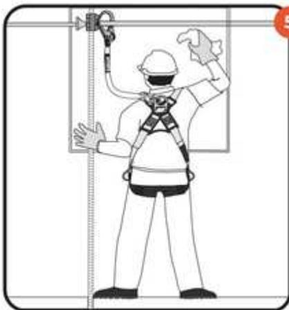
**5** Una línea de vida vertical debe estar bien sujeta de manera segura y se debe suspender libremente conectada desde su punto de anclaje, no debe hacer contacto con estructuras o cualquier otro objeto que puede afectar las condiciones iniciales de fabricación del equipo para su buen funcionamiento. Las líneas de vida con absorbedor se deben instalar de manera que evite que la estructura afecte el funcionamiento del absorbedor.
